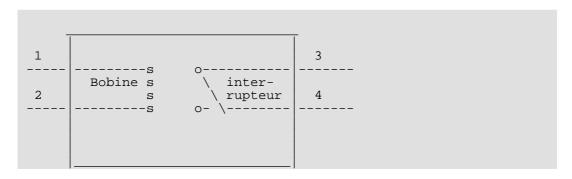
Dans le schéma ci-dessus, les bornes 3 et 4 ne sont pas reliées par défaut. Quand vous envoyez du +12 V entre les bornes 1 et 2, ça déclenchera l'interrupteur, et les broches 3 et 4 seront reliées.
