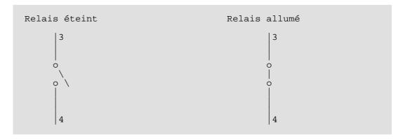
Le schéma suivant montre le fonctionnement d'un relais à 4 bornes.
