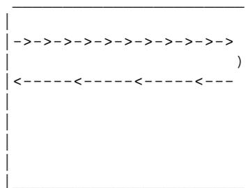
La fréquence de synchronisation horizontale représente le nombre de fois par seconde que le faisceau d'électrons du moniteur peut parcourir un chemin semblable à celui-ci
