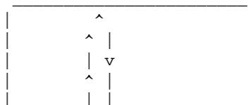
La fréquence de synchronisation verticale représente le nombre de fois par seconde que le faisceau d'électrons du moniteur peut parcourir un chemin semblable à celui-ci
