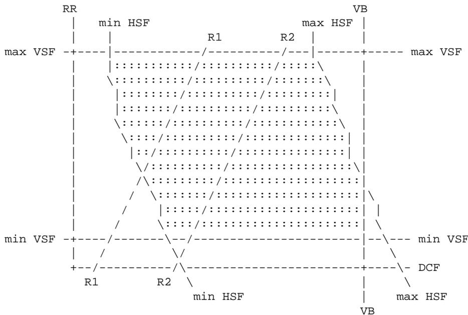
Ce graphique appelé diagramme de mode traduit les capacités d'un moniteur classique. Sur l'axe des x sont placées les fréquences pilotes (DCF), sur l'axe des y les fréquences de rafraîchissement (RR). La région noircie du diagramme représente les capacités du moniteur : chaque point à l'intérieur de cette région est un mode graphique possible.
