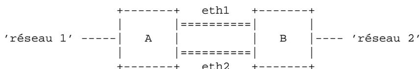
A et B sont des routeurs dont nous supposons qu'ils fonctionnent avec Linux pour le moment. Si le trafic va du réseau 1 vers le réseau 2, le routeur A a besoin de distribuer les paquets sur les deux liens allant vers B. Le routeur B a besoin d'être configuré pour l'accepter. On retrouve la même chose dans le sens inverse, pour les paquets allant du réseau 2 vers le réseau 1. Le routeur B a besoin d'envoyer les paquets à la fois sur eth1 et eth2.
