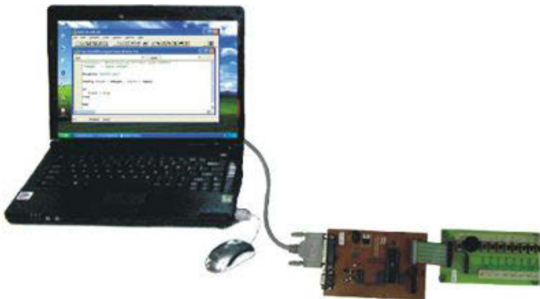
Gambar 3.1 Sambungan kabel LPT modul mikrokontroller dengan komputer
