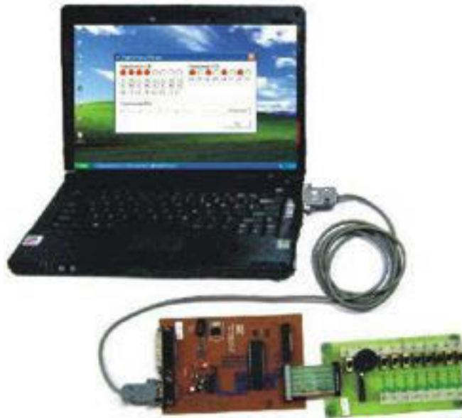
Gambar 4.12 Koneksi antara PC dengan mikrokontroller
