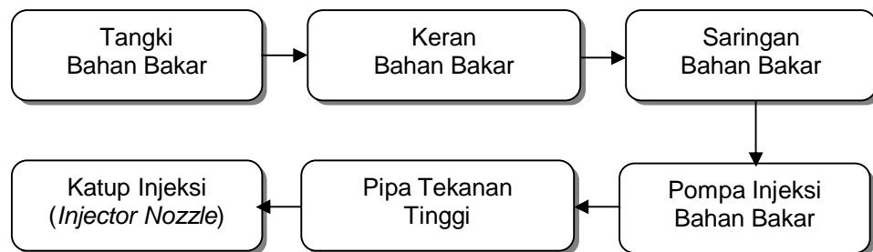
Gambar 15 Diagram Alir Sistem Bahan Bakar
